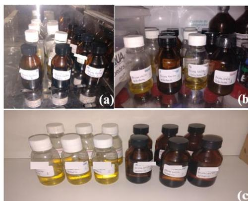
O método utilizado nesta pesquisa foi o Ca 5a-40 da AOCS<sup>11</sup>, no qual consiste em uma titulação volumétrica ácido-base. Como titulante, é usado uma solução de Hidróxido de Sódio (NaOH) de concentração 0,01 mol/L, sendo necessária
